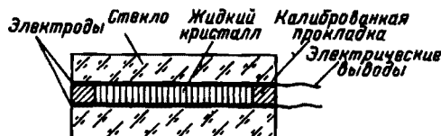
Рис. 12.8. Жидкокристаллическая ячейка для исследования оптических и электрических свойств жидкокристаллического объекта
