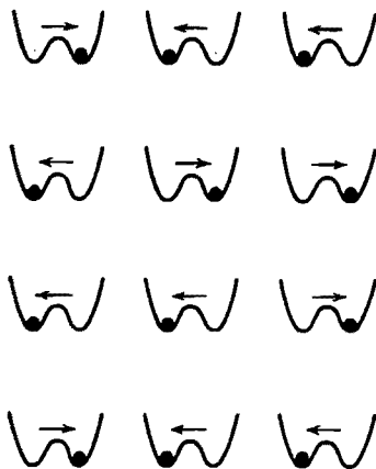
Рис. 8.1. Система неупорядоченных реверсируемых диполей в сегнетоэлектрическом кристалле типа порядок–беспорядок
