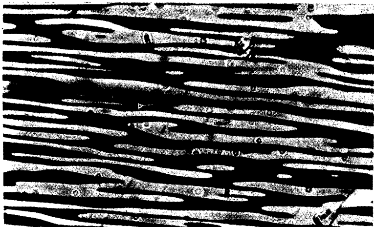
Рис. 10.15. Снимок доменной структуры кристалла ТГС (срез перпендикулярен направлению P_{\text{сп}} ) [13]
